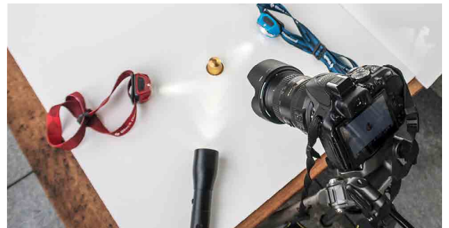
Das Fotosetting kann mit einfachsten Mitteln erfolgen. Stativ, Kamera und Taschenlampen. Schärfentiefe ist gefragt, also mit kleinster Blende fotografieren.
